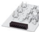
헤더, 정격 전류: 12 A, 정격전압(III/2): 320 V, 핀 수: 6, 간격: 5 mm, 색상: 검정색, 접점 표면: 주석, 마운팅: THR납땜, THR(Through Hole Reflow) 기술에 대한 사용자 정보와 설계 권장 사항은 "다운로드"에서 확인할 수 있습니다.
