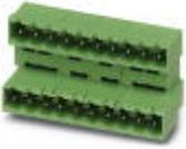
헤더, 정격 전류: 10 A, 정격전압(III/2): 320 V, 핀 수: 6, 간격: 5 mm, 색상: 녹색, 접점 표면: 주석, 마운팅: 웨이브 솔더링, 이 제품을 정렬하여 다른 수의 포지션을 만들 수 있습니다. MVSTB 또는 FKCV 플러그 컴포넌트와 함께 사용하는 경우 MVSTBW(또는 FKCVW) 및 MVSTBR(또는 FKCVR) 플러그를 모두 사용해야 합니다. TMSTBP 플러그 컴포넌트와 함께 사용할 수 없습니다.
